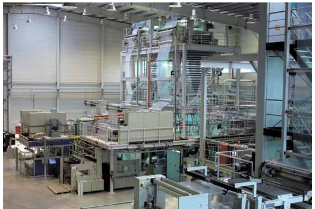
Blasfolien werden auf einem 3-Schicht-, drei 5-Schicht- und drei 7-Schicht-Extrusionsanlagen (hier Folien mit bis zu 14 Schichten) hergestellt.
